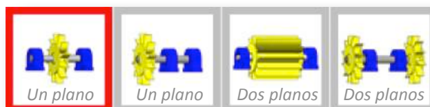
Fig. 8. En función de la geometría del rotor, el programa de equilibrado del equipo PRE5140 nos recomienda equilibrar en uno o dos planos.
