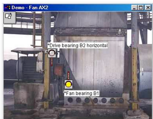
Fig. 19. El software PRE5140 dispone de ventanas con imágenes que identifican las máquinas para localizar las máquinas con alertas o alarmas, de una manera práctica e intuitiva.
